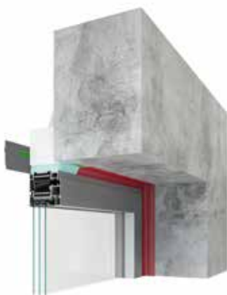
felső csatlakozás párazáró szalaggal és ragasztó tömítéssel
