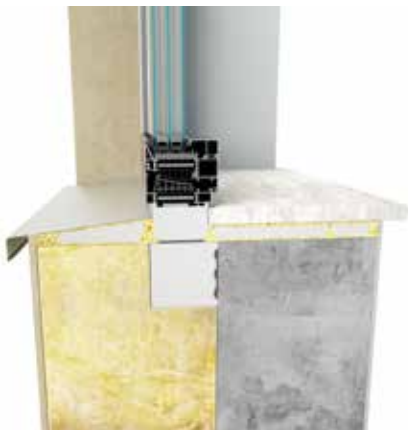
keresztmetszet a hőszigetelő rétegbe épített ablakon keresztül
